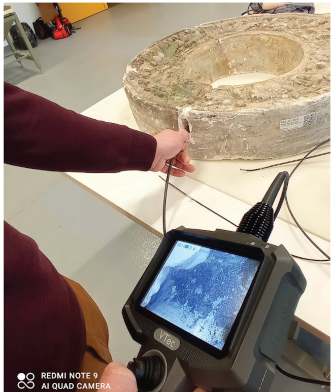
4. kép. A tondókeret belső szerkezetének vizsgálata endoszkóppal
