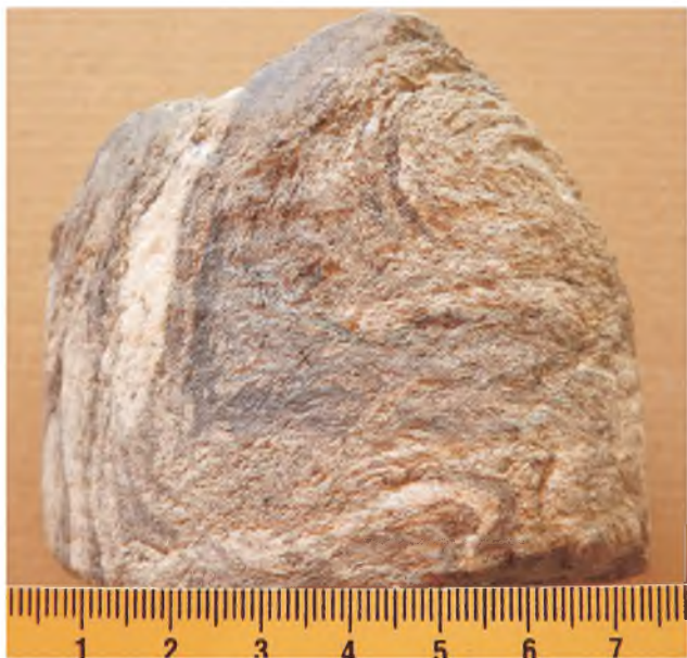
Gyűrt csillámpala makroszkópos megjelenése a magpaláston, Csanádapáca Csa-8 fűrés, 1929–1939 m (RVA)
