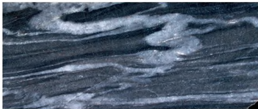
A gyűrt belső szerkezetet durvaszemű, a palássághoz képest pretektonikus kalciterek jelzik, Abod, Abodi-völgy (KB)
