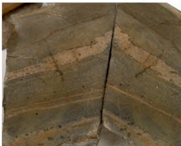
Finomszemcsés metahomokkő. A vastagabb, világosabb színű, durvább szemcsés homokkőréteg a kőzet eredeti rétegzését jelzi, amelyben apróbb parazitaredők észlelhetők. A kép hossze 9 cm (KB)
