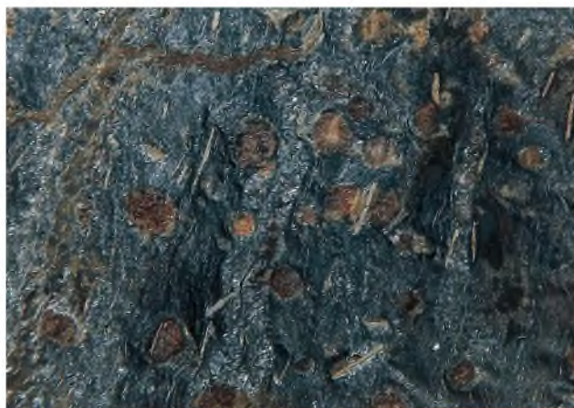
Gránátos, kétsillámú pala metszete, Pusztaföldvár Pf-227 fűrés, 1691–1693 m (RVA)
