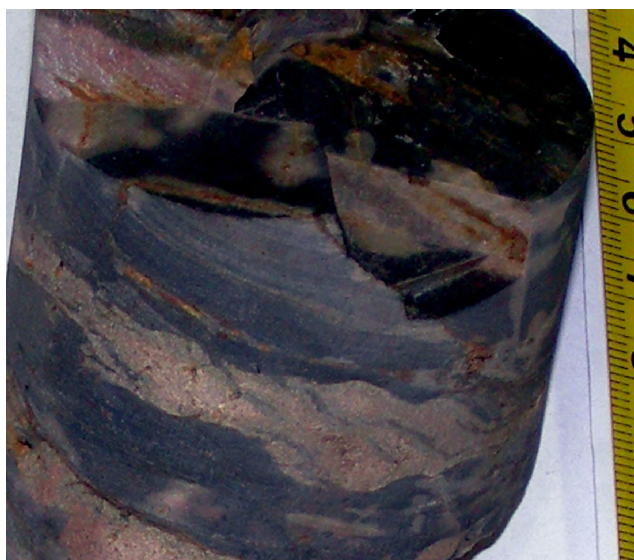
Sötétszürke agyagpala–metaaleurolit váltakozása deformált, hematittal impregnált metahomokkővel (Hh–1 fúrás, 779,6 m (ME))
