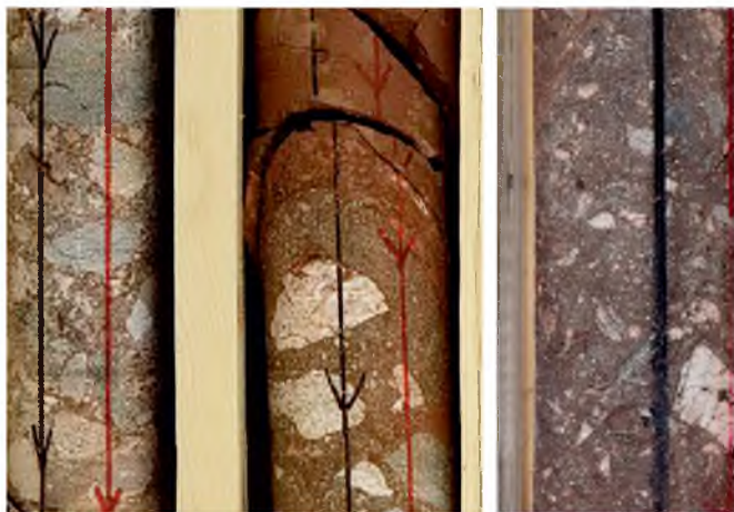
Szemcsevázú és mátrixvázú konglobreccsa a Boda BAF-1A fúrás rétegsorában (KGy)
