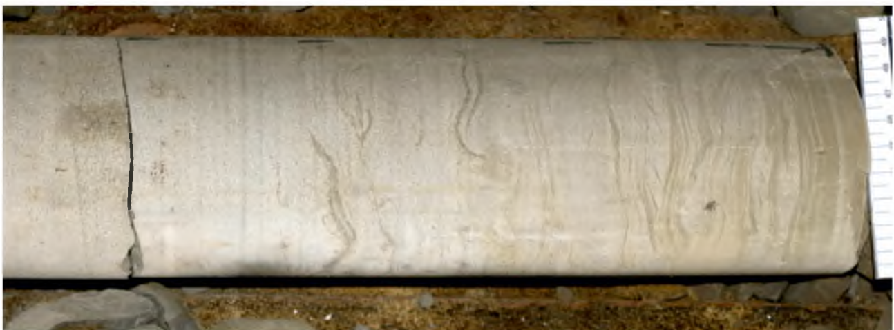
Szürke homokkő lemezes és konvolut szerkezettel, Bóly B-1 fúrás, 33. láda (SziO)
