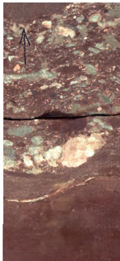
Fent: a Cserkúti Homokkő intraformációs, aleurolittörmelékös homokkőve–konglomerátuma és ártéri eredetű aleurolitja az Ibafa Ib-4 fúrásból, jobbra: mag szkenneres felvétel a Cserkúti Homokkőről, Ibafa Ib-4 fúrás, 427,66–428,20 m (KGy)
