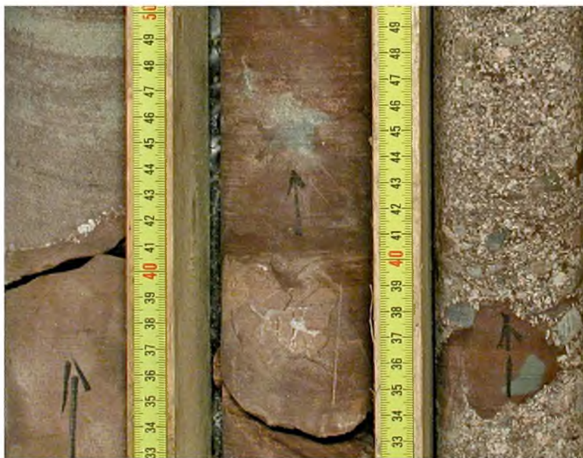
Fent: a Cserkúti Homokkő intraformációs, aleurolittörmelékös homokkőve–konglomerátuma és ártéri eredetű aleurolitja az Ibafa Ib-4 fúrásból, jobbra: mag szkenneres felvétel a Cserkúti Homokkőről, Ibafa Ib-4 fúrás, 427,66–428,20 m (KGy)
