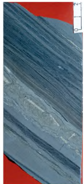
Átülepített bioklasztokból álló mészkőrétteg márgában, Rezi, Rz-4 fúrás (HAAS [szerk.] 2004)
