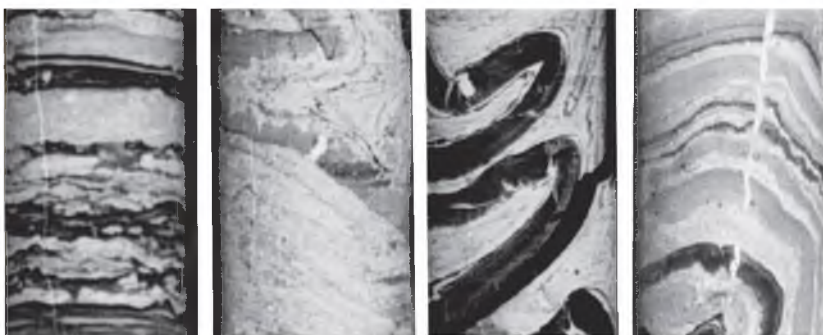
Magyarürögi Anhidrit gipsz-, agyagkő-, anhidrit- és dolomitrétegei (VII. szerkezetkutató fúrás)
