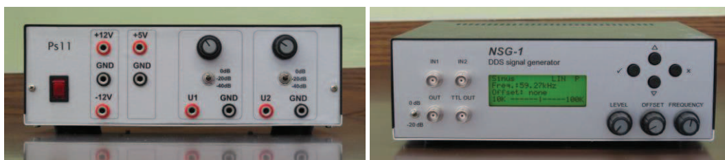
1. ábra - A tápegység (balra) és a jelgenerátor (jobbra). Mind a tápegységet, mind a jelgenerátort hallgatók terveztek és szerelték össze, a laboratóriumi gyakorlatok igényeit figyelembe véve.
