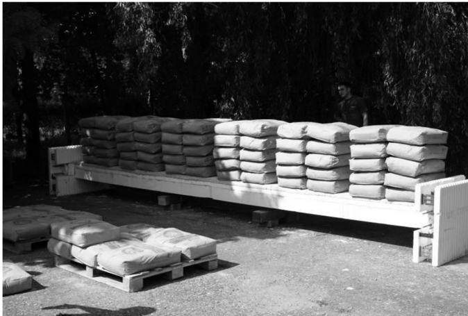
1. ábra: Födém elem terhelési teszt
