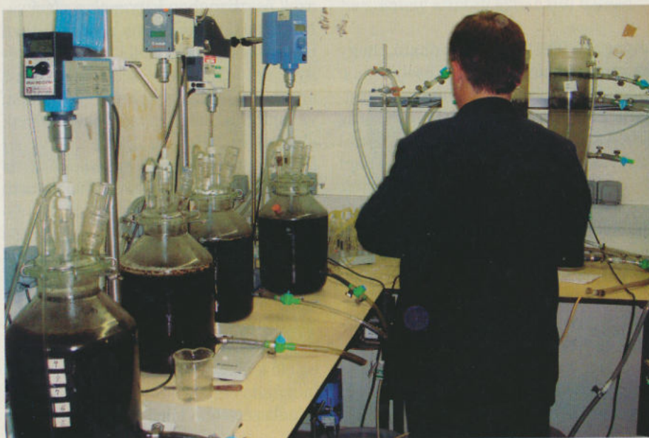
Laboratóriumi biogázképződés automatikus irányítása és felügyelete
