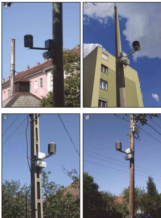
3. ábra: Néhány példa a mérőállomások elhelyezésére (a) acél és (b) beton kandeláberen, illetve (c) beton és (d) fa villanyoszlopon
