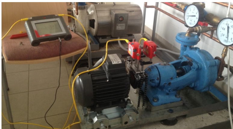
2. ábra Lézeres egytengelyűség beállítás
